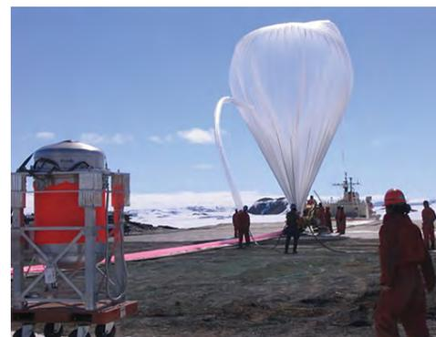
図3. 大気球を利用すると、高度10-30kmの成層圏の大気を採取して温暖化ガスやオゾン層破壊ガスの濃度を調べることができます。これまで南極昭和基地など世界の数か所で実験をしてきました。
