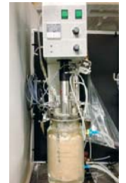
図3 油脂を処理しているメタン発酵装置
