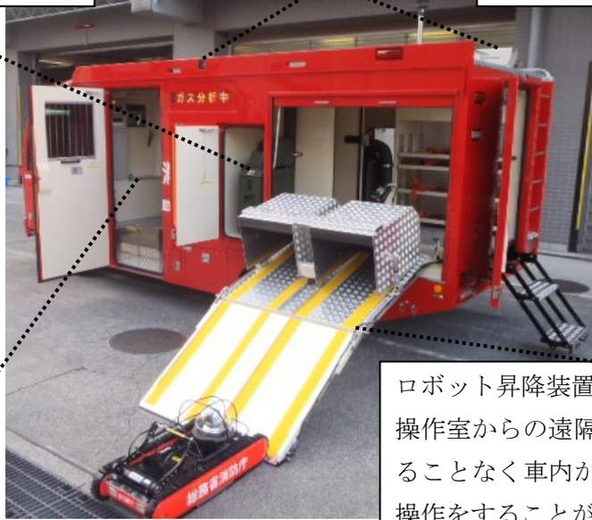
ロボット昇降装置（電動油圧式）
