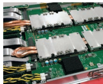
計算ノードの内部。4基のGPUを冷却する
