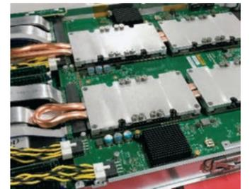
計算ノードの内部。4基のGPUを冷却する
