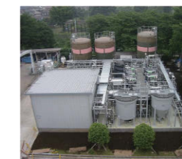
銅を含むメッキ工場排水処理(沈殿分離法)の改善例(銅含有率の高い沈殿物を生成させて有価物化する)
