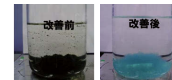
銅を含むメッキ工場排水処理(沈殿分離法)の改善例(銅含有率の高い沈殿物を生成させて有価物化する)
