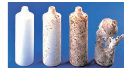
図2 生分解性プラスチックの分解の様子(日本バイオプラスチック協会HPより)
