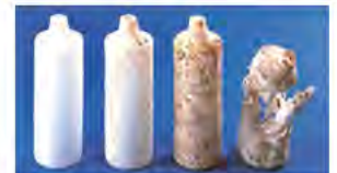
図2 生分解性プラスチックの分解の様子（日本バイオプラスチック協会HPより）
