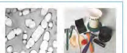
図1 生分解性プラスチックを蓄えた微生物の電子顕微鏡写真（左）とその製品例（右）
