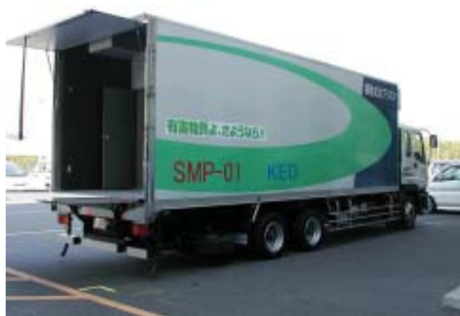
移動式の廃棄物処理装置 10トントラックに発電機やプラズマ発生装置、排気処理装置などを搭載
